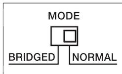
Schalter zum Umschalten von Normal- (Stereo) in den Bridged-Mode. Im Bridged-Mode arbeiten die eingebauten Endstufen im „Gegentakt“ und an der Bridged Buchse erscheint die doppelte Ausgangsspannung von Kanal A und B. Kanal A und B arbeiten also gegeneinander phasengedreht und dürfen nicht mehr als Lautsprecherausgänge benutzt werden.
